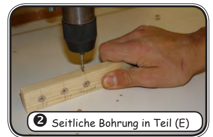
❷ Teile (B), (C), (D), (E), (F) bohren
