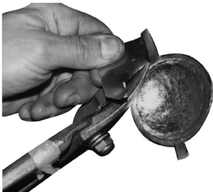
ausschneiden mit Blechschere
