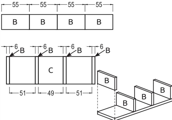
Übertrage die **Maße** der Teile (B) auf das Sperrholz und säge sie mit einer **Feinsäge** oder **Laubsäge** zurecht. Arbeite die Kanten und Flächen der Teile (B, C, D) mit Schleifpapier nach. **Leime** die Teile (B) nach Abbildung auf Teil (C).  OK ✓
